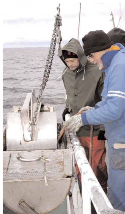
Bottenproverna tas med en huggare som täcker en tiondel kvadratmeter. Metoden används även i Högskolans undervisning, här på plats i Kalmarsund.
