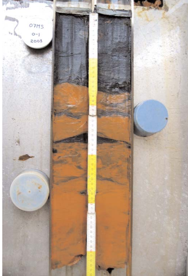
Sedimentkärna, upptagen från botten av Oskarshamns hamnbassäng. Den kraftiga missfärgningen beror på förorening av tungmetaller. Det översta lagret är däremot svart på grund av syrebrist.
