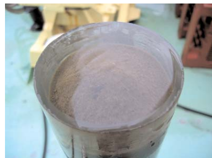
Ett örört sedimentprov i närbild. Tungmetallhalterna undersöks i den översta centimetern som motsvarar 2-3 års tillväxt av sedimenten.
