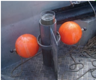
Sedimentfälla med flytkroppar som håller fällan upprätt i vattnet. FOTO: INGEMAR CATO
